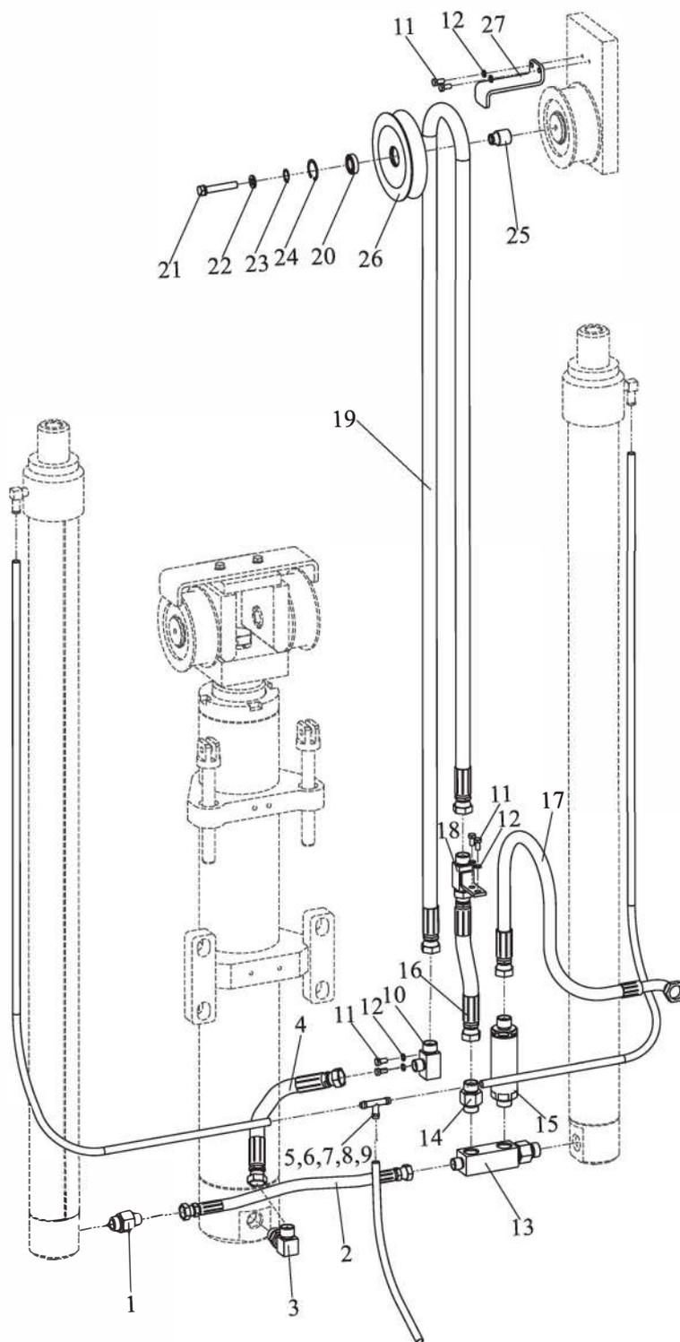
Гидравлическая система мачты (3-х секционная мачта со свободным ходом TFV)
