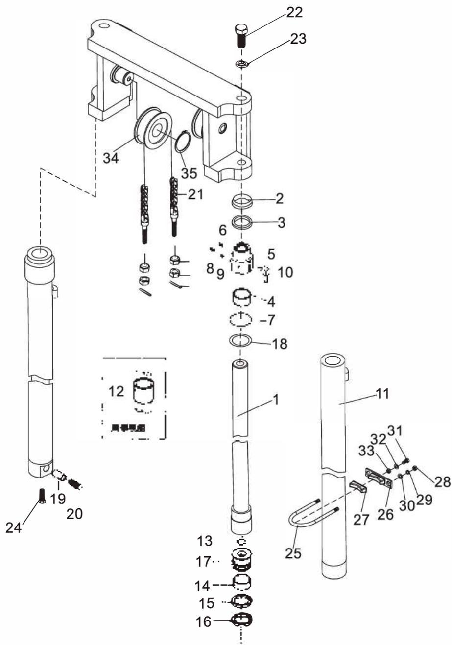
Задний подъемный цилиндр (3-х секционная мачта TFV)
