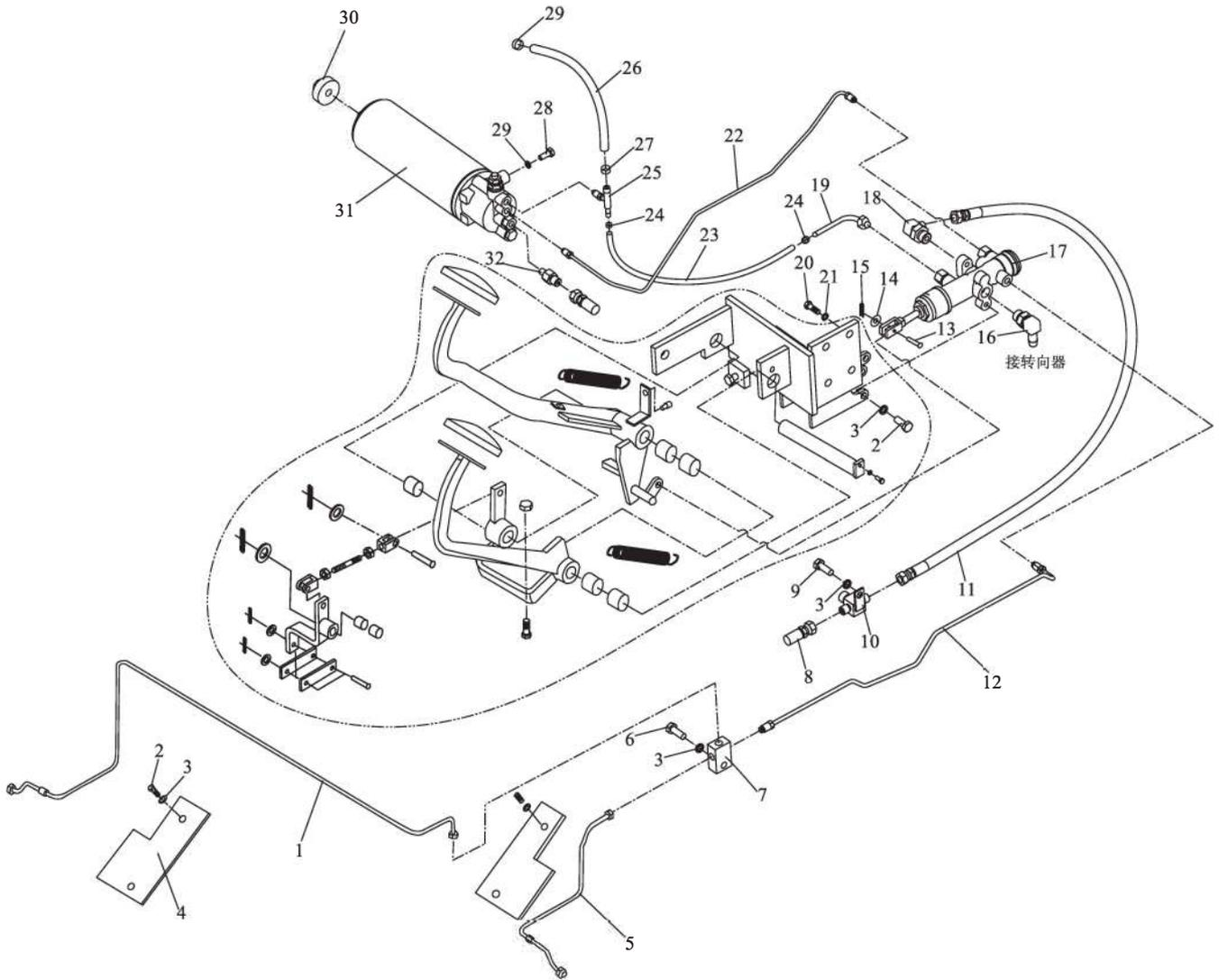
Система тормозных трубопроводов
