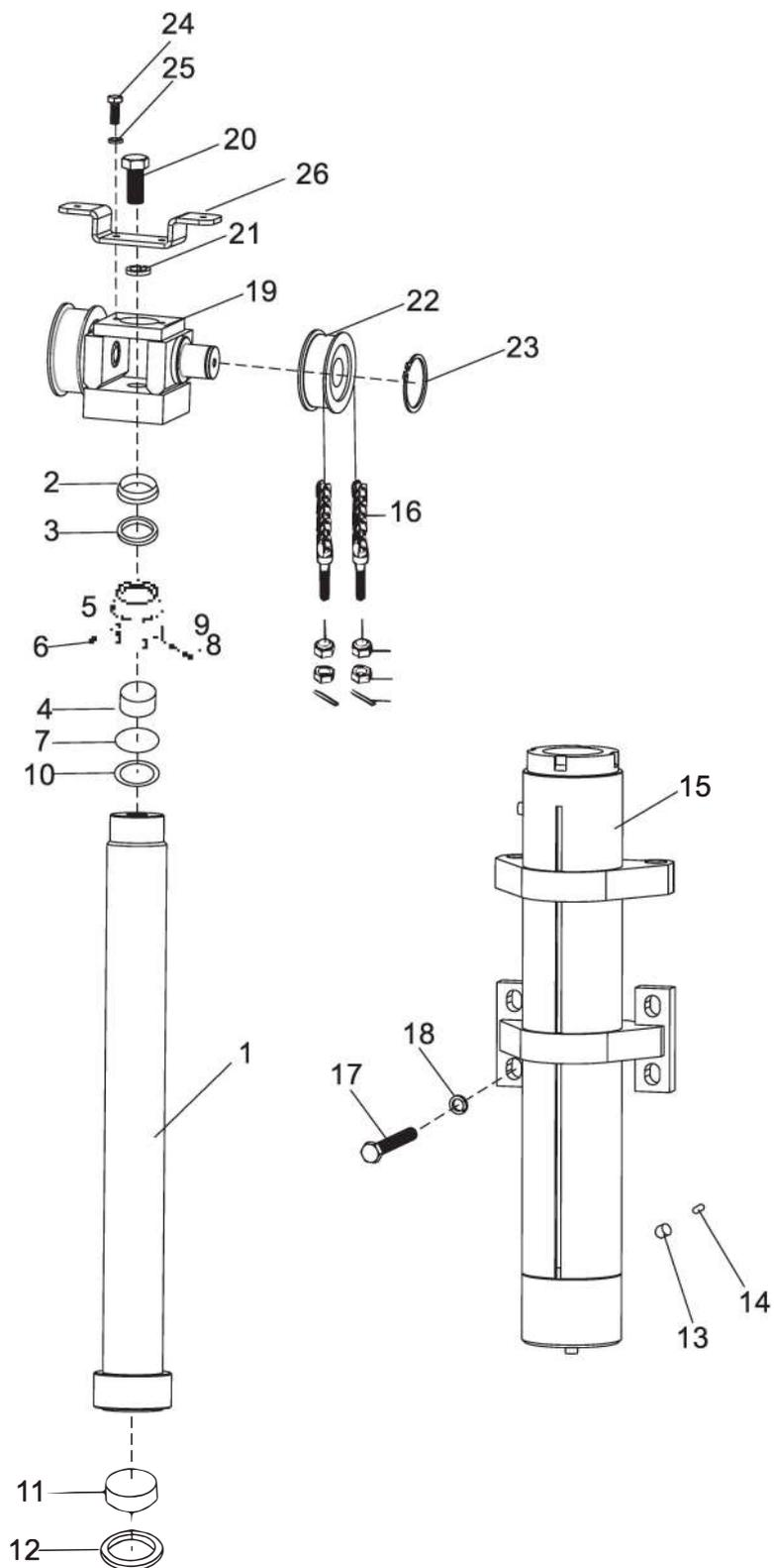
Передний подъемный цилиндр (2-х секционная мачта FFV)
