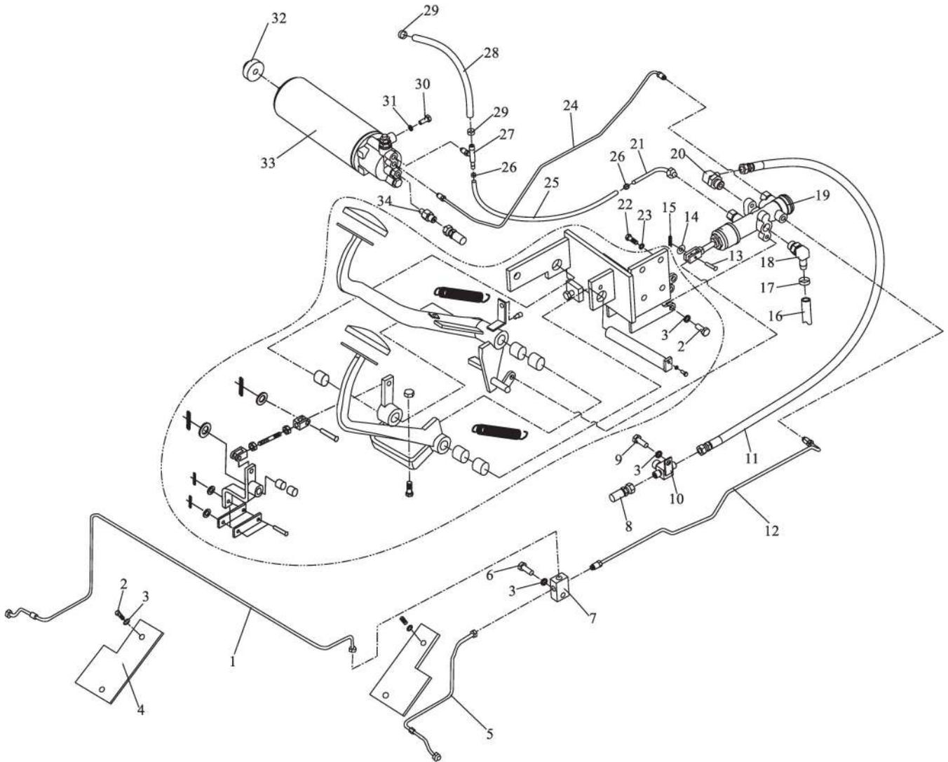
Система тормозных трубопроводов
