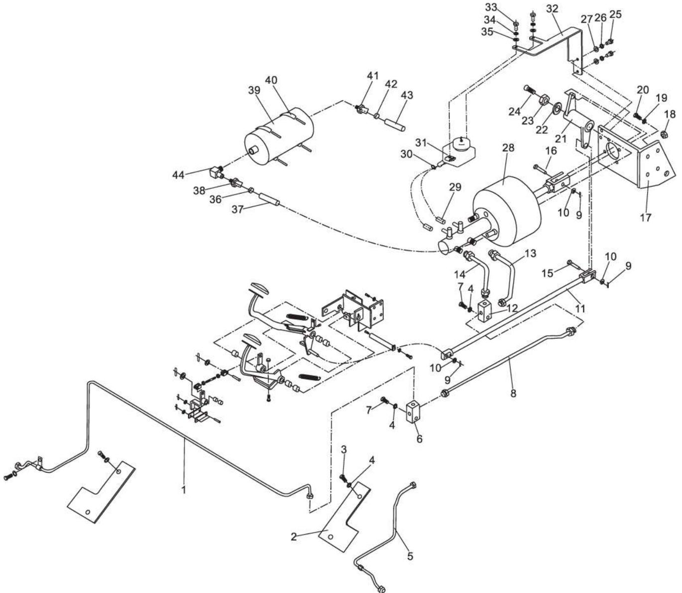
Система тормозных трубопроводов
