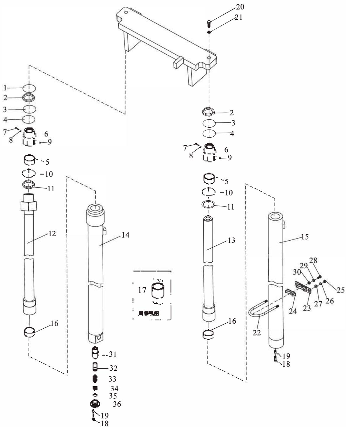
Задний подъемный цилиндр (2-х секционная мачта FFV)
