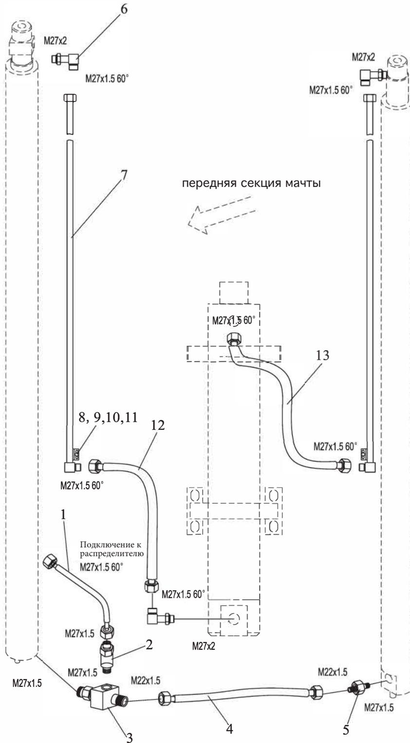
Гидравлическая система мачты (2-х секционная мачта со свободным ходом FFV)
