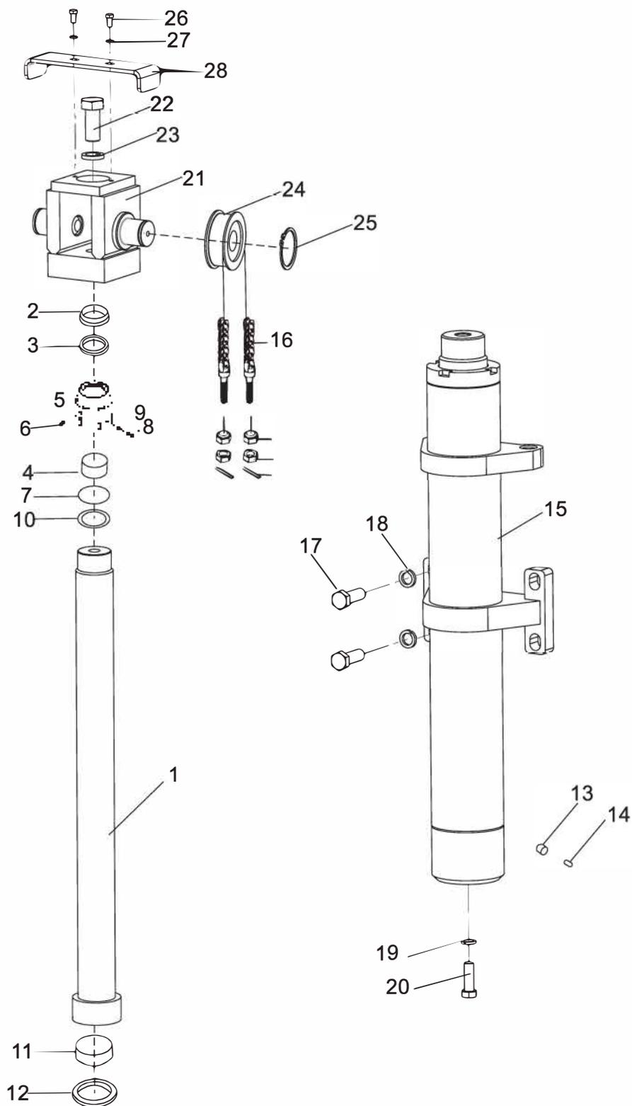
Передний подъемный цилиндр (3-х секционная мачта TFV)
